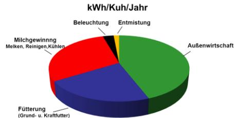
kWh: Außen 600, Fütterung 300, Milch 400, Beleucht. 40, Entm. 20
