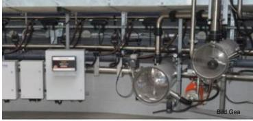
Füllstandsabhängiges Arbeiten der Milchförderpumpe
